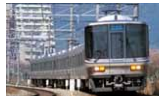
電力回生ブレーキを利用した223系車両
